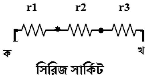
এখানে  $r_1$ ,  $r_2$  ও  $r_3$  তিনটি রোধকে সিরিজে যোগ করা হয়েছে। এই সার্কিটে ক ও খ দুই প্রান্তের মোট রোধ  $Rs. = (r_1 + r_2 + r_3) \Omega$  (ওহম)
